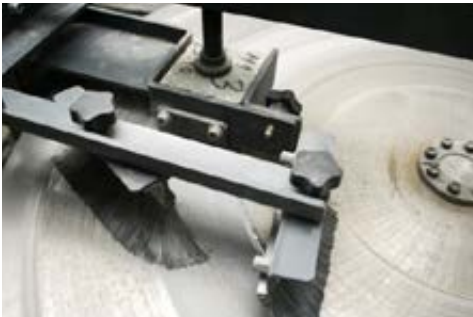
DLAŽBA PRI SKÚŠKE OBRUSNOSŤ POVRCHU
