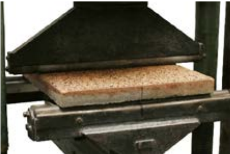
DLAŽBA PRI SKÚŠKE PEVNOSŤ V OHYBE
