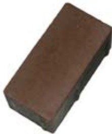
Povrch dlažby bez vápenného výkvetu
