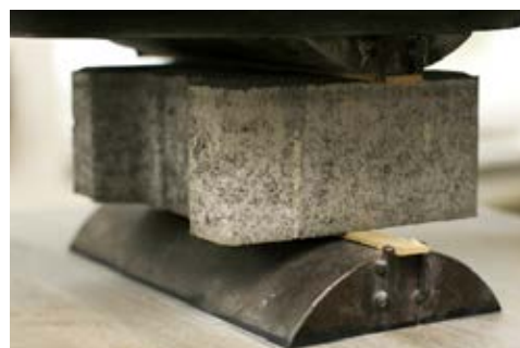
DLAŽBA PRI SKÚŠKE PEVNOST V PRIEČNOM ŤAHU
