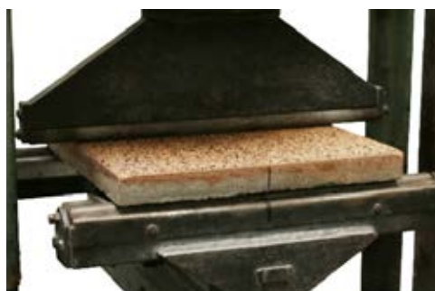
DLAŽBA PRI SKÚŠKE PEVNOSŤ V OHYBE
