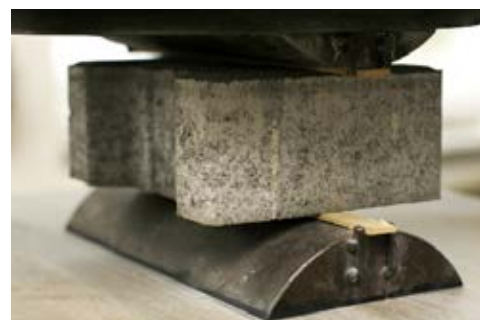
DLAŽBA PRI SKÚŠKE PEVNOSŤ V PRIEČNOM ŤAHU
