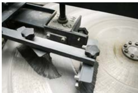
DLAŽBA PŘI ZKOUŠCE OBRUSNOST POVRCHU
