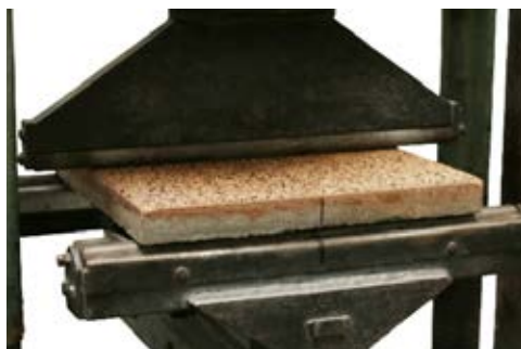
DLAŽBA PŘI ZKOUŠCE PEVNOST V OHYBU
