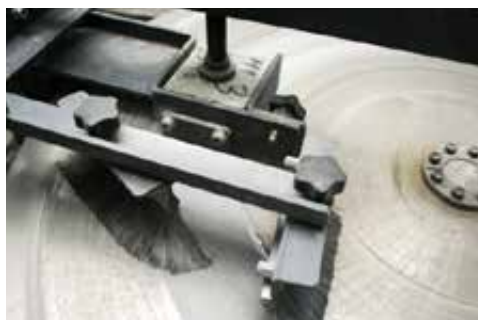
DLAŽBA PRI SKÚŠKE OBRUSNOSŤ POVRCHU
