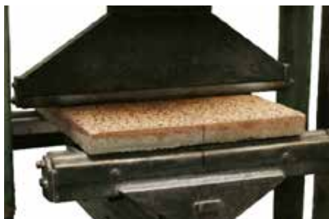
DLAŽBA PRI SKÚŠKE PEVNOSŤ V OHYBE
