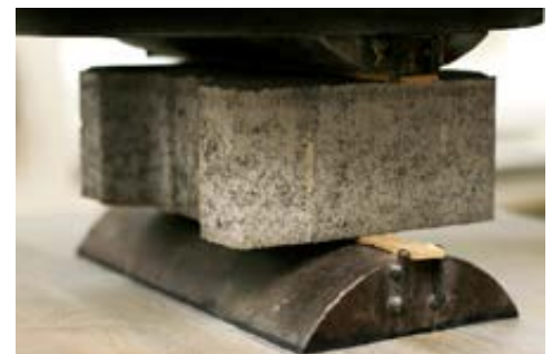
DLAŽBA PRI SKÚŠKE PEVNOSŤ V PRIEČNOM ŤAHU
