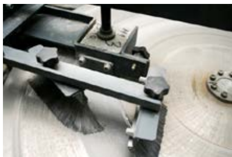
DLAŽBA PRI SKÚŠKE OBRUSNOSŤ POVRCHU
