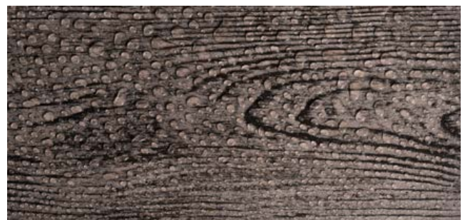
POVRCH DLAŽBY S ÚPRAVOU DEP
