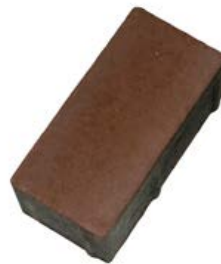
Povrch dlažby bez vápenného výkvetu
