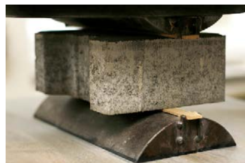
DLAŽBA PRI SKÚŠKE PEVNOSŤ V PRIEČNOM ŤAHU
