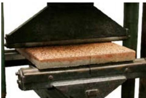
DLAŽBA PRI SKÚŠKE PEVNOSŤ V OHYBE
