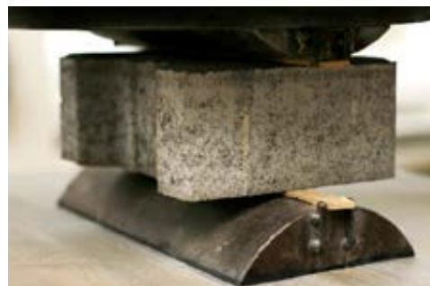
DLAŽBA PRI SKÚŠKE PEVNOSŤ V PRIEČNOM ŤAHU
