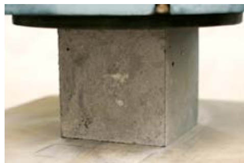
BETÓN PRI SKÚŠKE PEVNOSŤ V TLAKU
