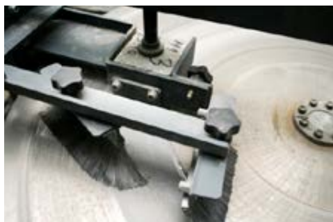
DLAŽBA PRI SKÚŠKE OBRUSNOSŤ POVRCHU
