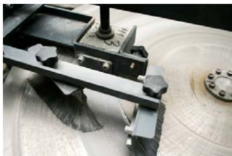
DLAŽBA PRI SKÚŠKE OBRUSNOSŤ POVRCHU
