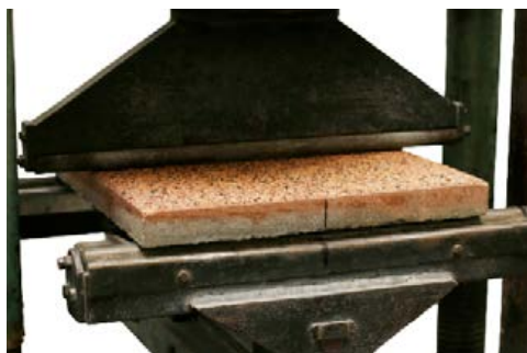
DLAŽBA PRI SKÚŠKE PEVNOSŤ V OHYBE
