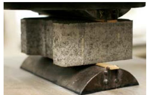
DLAŽBA PRI SKÚŠKE PEVNOSŤ V PRIEČNOM ŤAHU
