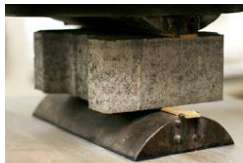
DLAŽBA PRI SKÚŠKE PEVNOSŤ V PRIEČNOM ŤAHU
