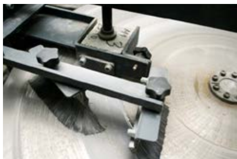
DLAŽBA PRI SKÚŠKE OBRUSNOSŤ POVRCHU
