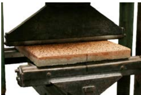
DLAŽBA PRI SKÚŠKE PEVNOSŤ V OHYBE
