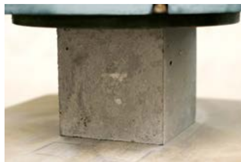
DLAŽBA PRI SKÚŠKE PEVNOSŤ V TLAKU
